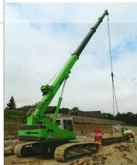
Der hydraulisch teleskopierbare Unterwagen sorgt in Verbindung mit einem B6 Laufwerk mit 700 mm 3-Steig-Bodenplatten für einen sicheren Stand.
